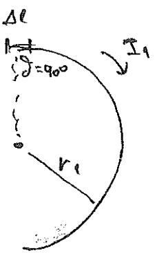
$$\text{Einer } \Delta B = \frac{\mu_0}{4\pi} I_1 \frac{\Delta l}{r_1^2}, \text{ mit}$$
