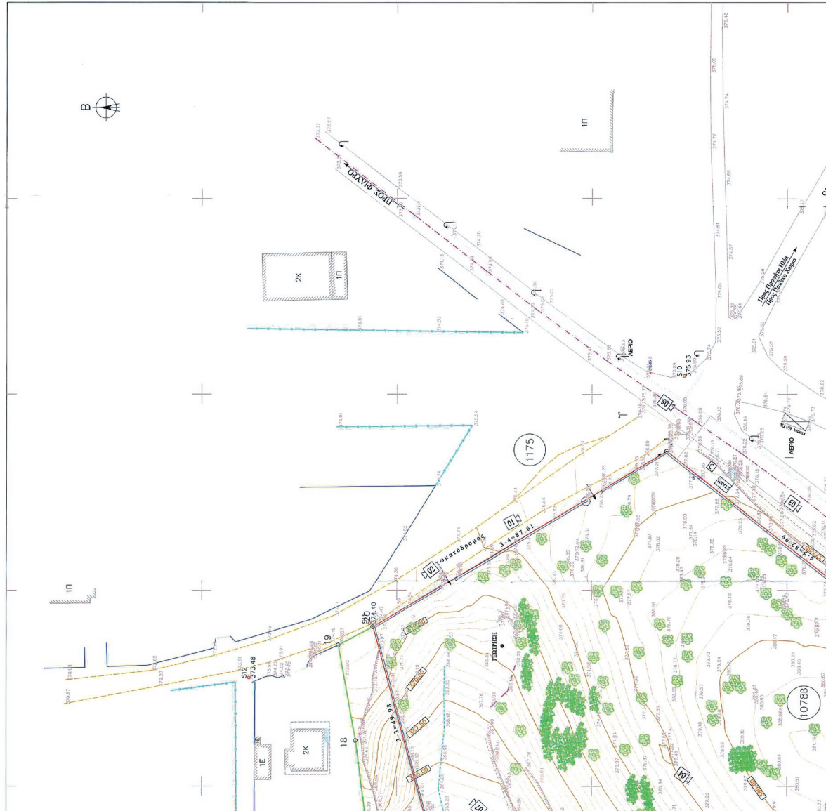
ΥΠΟΛΟΓΙΣΤΟΣ ΕΜΒΛΑΟΥ ΑΝΑΛΥΤΙΚΑ ΜΕ ΟΡΟΦΩΤΗΡΙΕΣ ΣΥΝΤΕΤΑΓΜΕΝΕΣ ΕΓΣΑ 87
